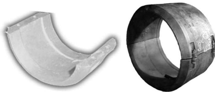
Предприятие изготавливает грузы чугунные кольцевые для баллаستировки нефте- и газопроводов диаметром от 530 мм до 1420 мм из серого чугуна СЧ10, СЧ15 (ГОСТ 1412-85).
